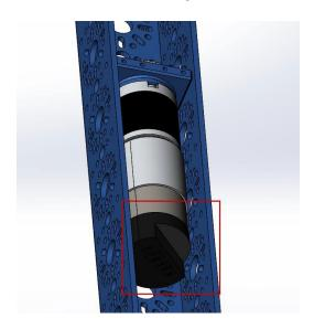
NOTE: THE ENCODER CAP SHOULD HAVE THE FLAT FACING THE OPEN.
