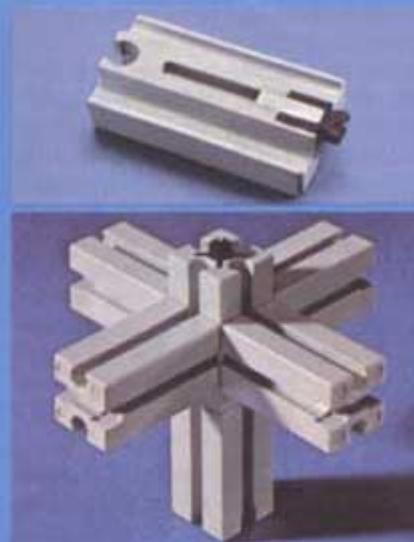
fischertechnik-Bausteinverbindungen halten eine Zugkraft von 10 kg und mehr aus. Die Bausteine sind stabil und formstreu. Durch einen Stahlstift ist der Verbindungszapfen im Baustein zusätzlich verankert. Jeder fischertechnik-Grundbaustein kann an allen 6 Seiten an jeder gewünschten Stelle winkelgerecht angebaut werden.
