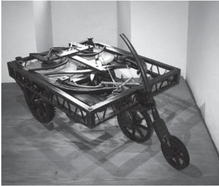
■ « Quel rapport y a-t-il entre Léonardo de Vinci et un moteur à ressort ? Les schémas, qu'il nous a laissés, comprenaient le modèle d'un véhicule à trois roues. Les éléments de son moteur se composaient de ressorts en bois et de roues dentées. Il fallait faire usage de la force des muscles pour tendre les ressorts. L'énergie accumulée dans les ressorts se transmettait aux roues de traction après le desserrage d'un verrouillage.
