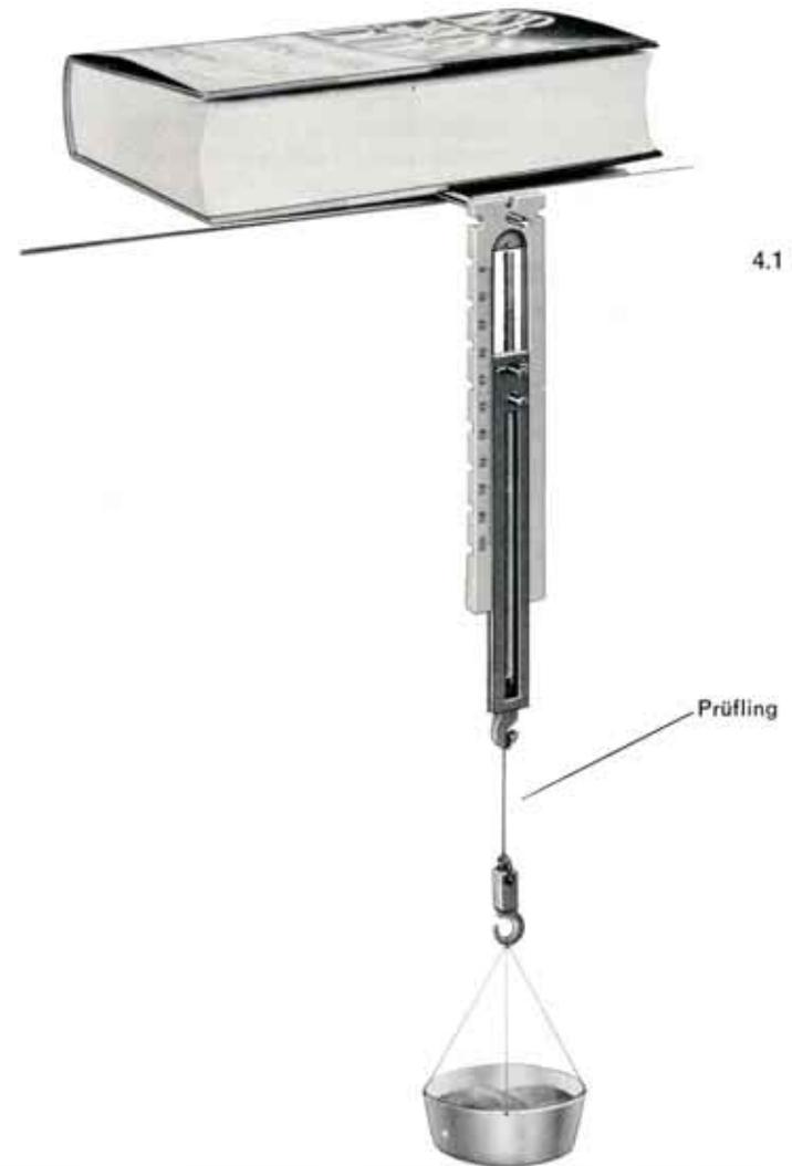
Federwaage angezeigt. Sie wissen ja, daß die Kraft, die der Behälter (Sandfüllung) infolge seines Gewichtes auf den Draht ausübt, eine Gegenkraft vom Haken der Federwaage auf das andere Ende des Probekörpers bedingt, denn nur dann ist das System im Gleichgewicht.
