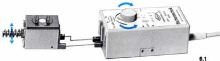
Die Höhe der Gleichspannung kann durch den Drehknopf zwischen Null und etwa 7 Volt in Stufen eingestellt werden.
