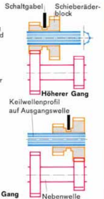
Bild 65.2 Schalten von Schieberädern
