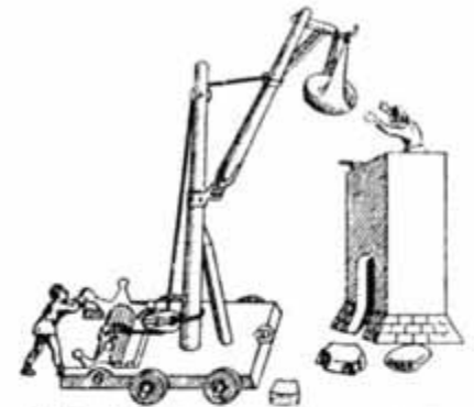
7.5 Baukran mit schwenkbarem Ausleger nach Taccola
