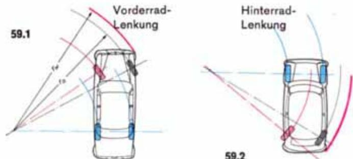
**Wendekreis** Der kleinste Wendekreis ist der Durchmesser des Kreises, den das am weitesten vorstehende Fahrzeugteil beim größten Lenkeinschlag beschreibt (Bild 59.1). Er ist in der Praxis von größerer Bedeutung als der Spurkreisdurchmesser, der, vermehrt um die Reifenbreite, als sogen. Bordsteinkreisdurchmesser für das Wenden auf der Straße interessant ist, wenn Karosserieteile noch auf den Gehweg ragen dürfen. Für das Rangieren von Fahrzeugen (Einparken) ist der kleinste Wendekreis maßgebend.
