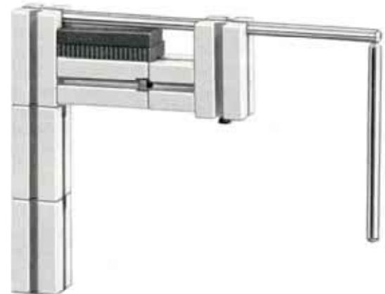
Der waagerechte Stab wirkt als Polschuh für den einen Pol des Dauermagneten. Der Polschuh ist in der Technik natürlich nicht als Rundstab, sondern als genau planauffliegende gleichgroße Platte ausgebildet. Mit diesem Modell können Sie die Schwingungsversuche nochmals wiederholen.
