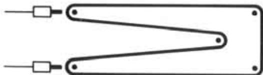
Die Skizze zeigt Ihnen die Befestigung und Umlenkung mittels Steckerbuchsen und fischertechnik-Kontaktstücken, Letztere sind nur als Halterung gedacht, sie haben also keine elektrische Funktion. Den Sollwert der Ofen-Temperatur können Sie einfach durch Höher- oder Tieferschieben des Festkontaktes unter dem Thermobimetall variieren.
