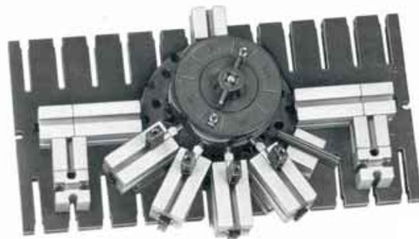
Motoranlasser Dasselbe Prinzip benutzt man, wenn ein Elektromotor mit einem Anlaß-Widerstand betrieben werden muß. Dieser in den Stromkreis geschaltete Widerstand wird stufenweise verkleinert. Das Schaltbild zeigt eine der Möglichkeiten mit dem fischertechnik-Schleifring.
