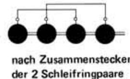
Durch ein Kabel können alle vier Schleifbahnen elektrisch verbunden werden.
