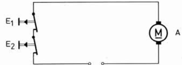
Der Motor bleibt bei beiden Schaltungen stehen, sobald an einem der beiden Ausgänge das Signal „1“ (= Taster gedrückt) anliegt.
