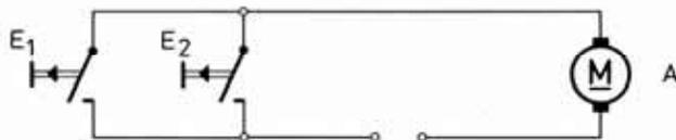
Diese Schaltung setzt man z. B. ein, wenn von mehreren Stellen aus eine Lampe oder ein Motor betätigt werden soll.
