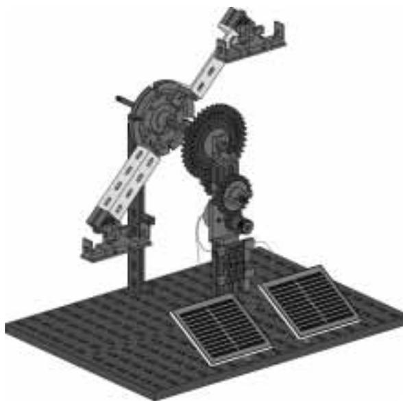
En este modelo el motor no debe girar demasiado rápido, porque de lo contrario dan un vuelco los asientos del columpio giratorio. Sin embargo, el modelo debe moverse con la menor cantidad posible de luz. Por este motivo han de conectarse en paralelo las dos células solares.
