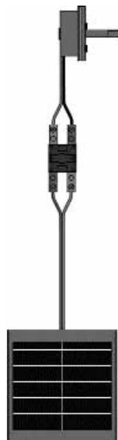
La célula solar suministra una tensión de 0,6 V y una corriente máxima de aprox. 930 mA. El motor posee una tensión nominal de 2 V, pero comienza a girar a partir de 0,3 V (en marcha en vacío, es decir sin que el eje del motor tenga que accionar un modelo). De esta forma puede ser operado con una sola célula solar.
