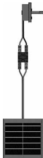
La photopile fournit une tension de 0,6 V et une intensité de courant maximale d'environ 930 mA. Le moteur possède une tension nominale de 2 V, mais commence déjà à tourner à partir de 0,3 V (à vide, c'est-à-dire lorsque l'arbre du moteur n'a pas à entraîner de maquette). Une seule photopile suffit donc à l'actionner.
