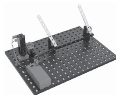
Limpiaparabrisas sincronizados forma constructiva habitual en automóviles
