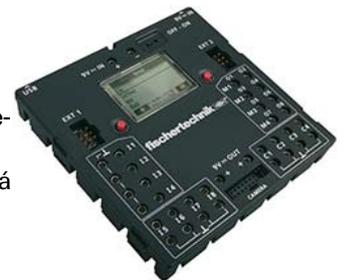
Una golosina especial es la interfaz Bluetooth integrada. A través de ella puedes conectar sin cables tu PC con el ROBO TX Controller. O también varios Controller entre sí. Como el Controller se maneja con los elementos individuales y qué es lo que individualmente deben hacer, lo determinas en el programa que escribes en el software ROBO Pro.
