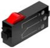
Le bouton est aussi appelé « détecteur de contact ». L'actionnement du bouton rouge a pour effet de produire une commutation mécanique : le courant circule entre les contacts 1 (contact moyen) et 3, tandis que le contact entre les raccordements 1 et 2 est interrompu. Vous pouvez vous servir du bouton de deux façons différentes :
